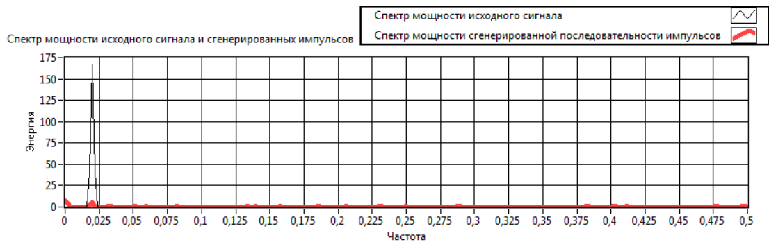
Рис. 5. Спектры мощности исходного сигнала и сгенерированной последовательности импульсов. (Временная область исходного сигнала приведена на рис. 1-3, временная область сгенерированной последовательности импульсов приведена на рис. 4)
