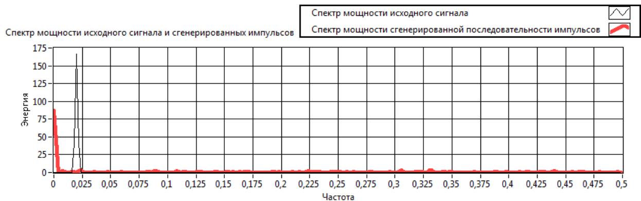
Рис. 6. Реализация спектров мощности исходного сигнала и сгенерированной последовательности импульсов при отношении амплитуды шума к амплитуде сигнала равном 100: сходство между двумя графиками утрачено; вид спектра мощности сгенерированных импульсов будет незначительно отличаться в зависимости от реализации шума
